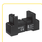
ES-15/4N - цоколь Макс.ток: 12 A. Вес: 59 гр. Монтаж на DIN рейку. Предназначено для 4-контактного реле.
