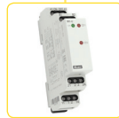
MR-42 Напряжение питания: AC 230 V и AC/DC 12 -240 V. Выходной контакт: 2x переключ. 16 A.
