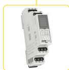
VS316/24 Напряжение питания: AC/DC 24 V. Выходной контакт: 3x переключ. 16 A, возможность подключ. к 3 - х фазному разводу.
