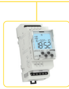
SOU-2 Сумеречный контактор с коммутирующим таймером. Напряжение питания: AC 230 V / 50 - 60 Гц Выходной контакт: 1x переключ. 8 A Встраиваемый модуль для батарейки резерв- ного хода.
