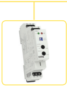
SOU-1 Сумеречный контактор. Напряжение питания: AC 230 V и AC/DC 12-240 V Выходной контакт: 1x переключ. 16 A.
